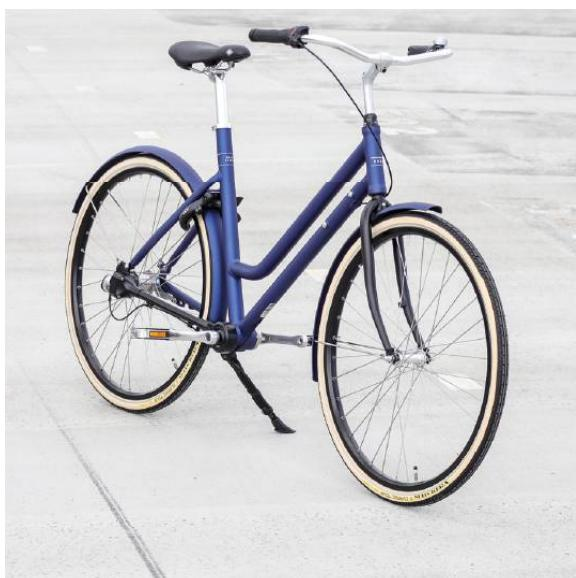
Brikbikes son bicicletas completamente únicas: desde el diseño y el estilo hasta el bajo mantenimiento pasando por la producción personalizada. Y lo mejor, ya no hay una cadena sucia y desagradable. Las bicicletas Brik llevan un cardan de bajo mantenimiento o una correa de carbono, dependiendo del modelo.
