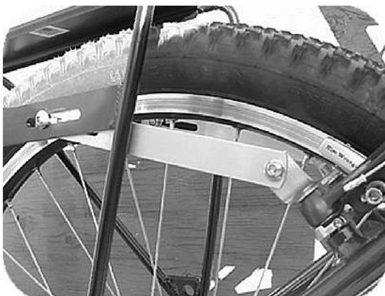
Retirar los tornillos blancos de freno asegurándose antes de no quitar o alterar los brazos del freno. Utilizar los tornillos de 16mm proporcionados para atornillar los soportes de aluminio angulados sobre el freno de taco (estos tornillos pueden reemplazar a los tornillos originales). Utiliza tornillos de 16mm para unir la barra extensible al soporte de aluminio angulado como se muestra en la imagen con la ranura en la parte trasera y el ángulo (esquina) fuera de la rueda.
