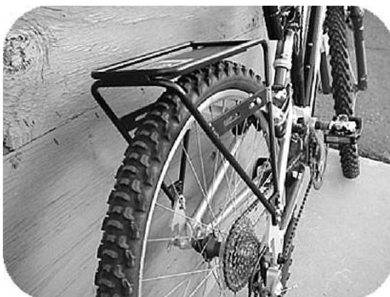
Retira la broqueta existente. Coloca la rejilla en el exterior del cuadro de la bicicleta y desliza el cierre suministrado a través del Kit Fitt de frenos y del eje. Haz girar la rejilla al nivel de posición y estira el cierre. Alinea las barras extensibles dentro de las ranuras de la rejilla. Sujetar con los tornillos de 16mm que quedan (ver imagen).
